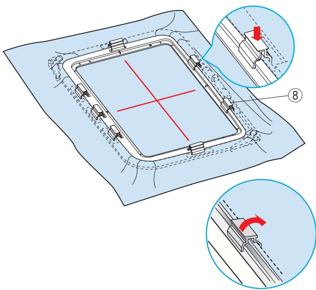
[6] Зафиксируйте ткань на пяльцах с помощью магнитов.
